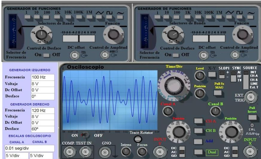
**Figura 4.5. Visualización de señal de frecuencia modulada**
