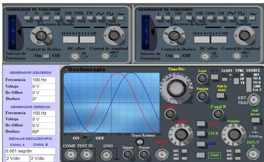
Figura 4.4. Visualización de diferencia en las fases entre dos señales
