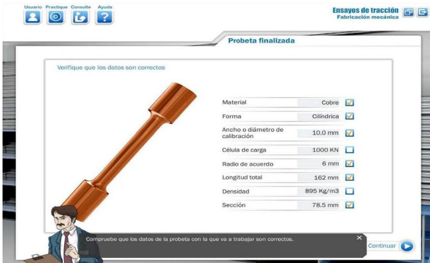
Figura 3.7. Preparación de la probeta a ensayar. (Fuente: INTEF. Web de simuladores de Formación Profesional)
