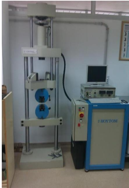
**Figura 3.2. Máquina universal de ensayos de tracción-compresión en centro educativo**
