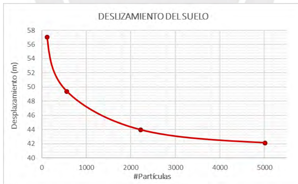
Fig. 62: Alcance del deslizamiento del suelo respecto al número de partículas. (Fuente Propia)
