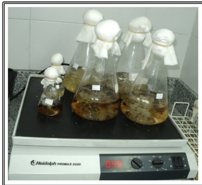
Figura V.3: Erlenmeyers de escala preparativa en agitador en sala climatizada.
