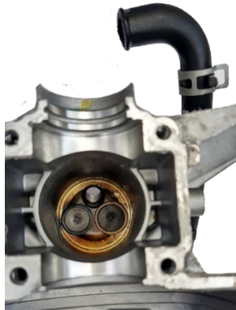
Figura 11. Interior de la cámara de combustión.
