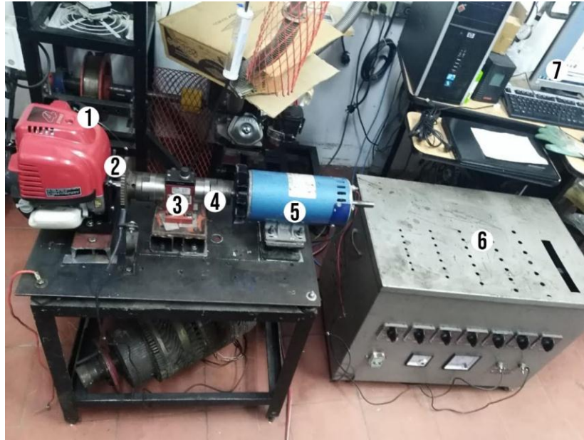
Figura 7. Dinamómetro eléctrico, configuración prueba 2.
