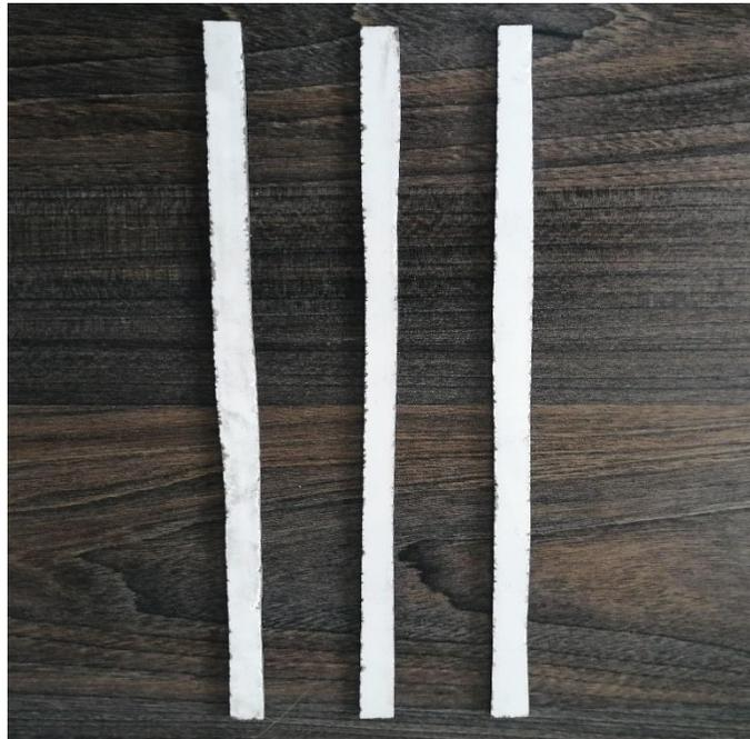
**Figura 11.** Probetas tracción carrocería. Fuente: [Autor].
