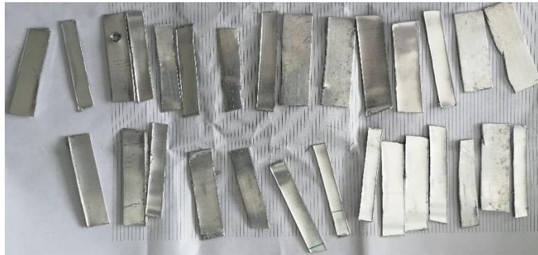
**Figura 12.** Láminas de aluminio para refuerzo. Fuente: [Autor]
