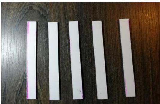
**Figura 9.** Probetas flexión carrocería Fuente: [Autor]
