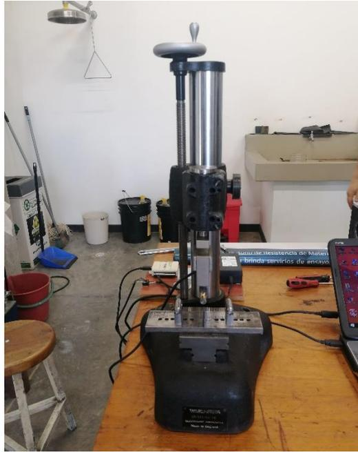
**Figura 19.** Equipo de ensayo para prueba de flexión. Fuente: [Autor]
