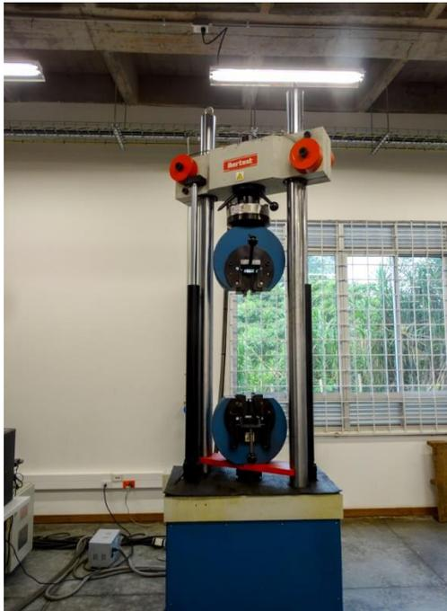
**Figura 22.** Máquina universal de ensayo para tracción.[17]
