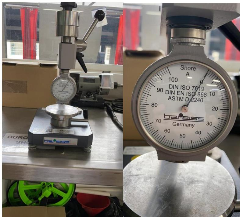
**Figura 25.** Equipo de dureza Shore. Fuente: [Autor]
