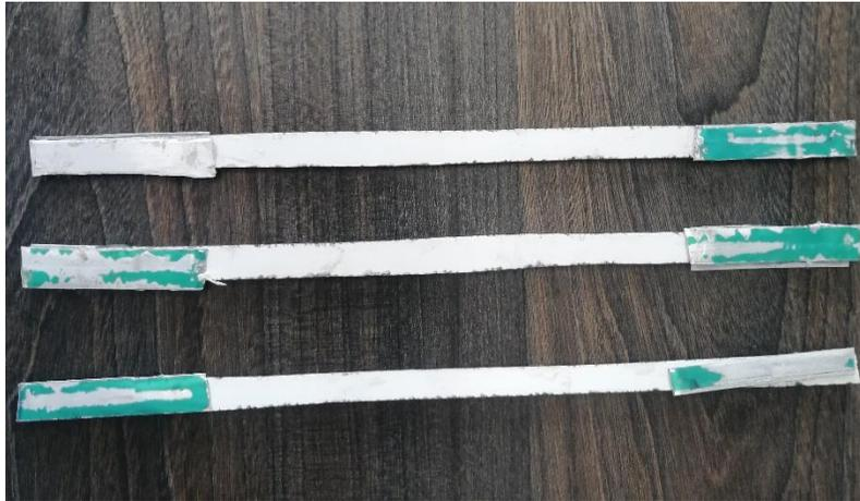
**Figura 14.** *Probetas tracción carrocería reforzadas.* Fuente: [Autor]
