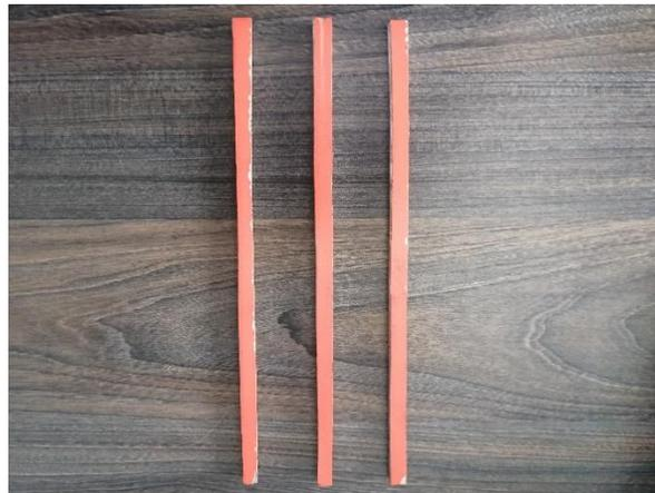
**Figura 17.** Probetas tracción para molde. Fuente: [Autor]
