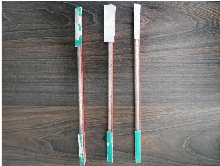
**Figura 18.** *Probetas tracción para molde con refuerzo de aluminio.* Fuente: [Autor]
