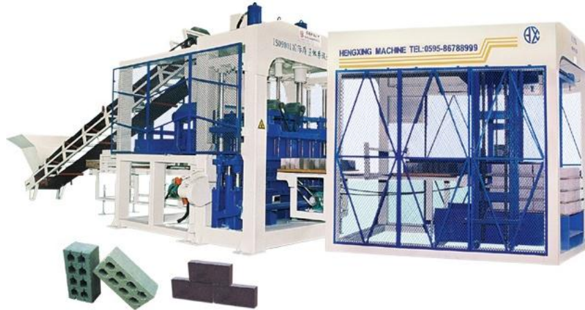
Figura 25. Sistema de prefabricados HQTY10-15
