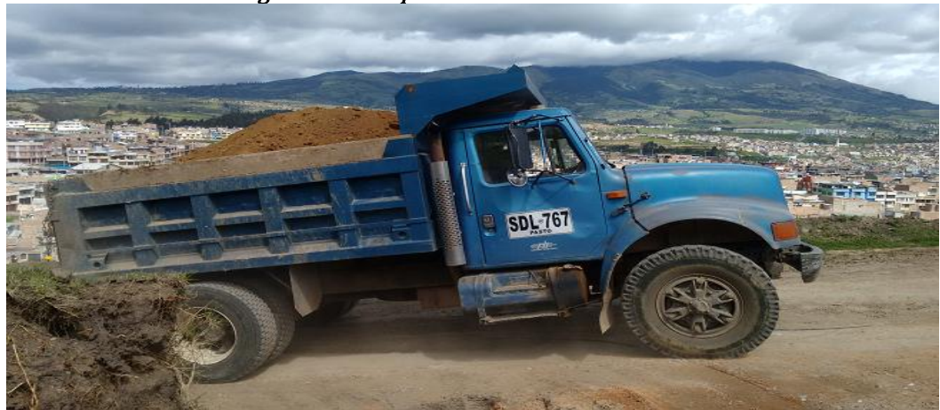
Fotografía 8. Transporte inadecuado de RCD
