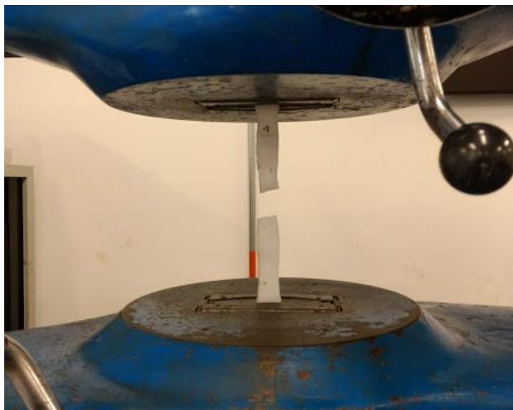
Ilustración 17– Rotura de probeta en ensayo de tracción. Fuente: Los autores .
