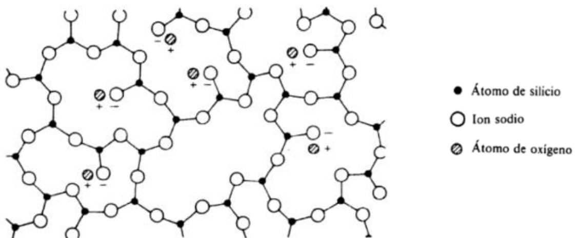
Ilustración 6 - Representación bidimensional de la estructura de la red polidéica de la fibra de vidrio. Fuente:
