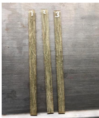
Figura 8. Probetas fibra de piña para ensayo tracción. Fuente, el autor.
