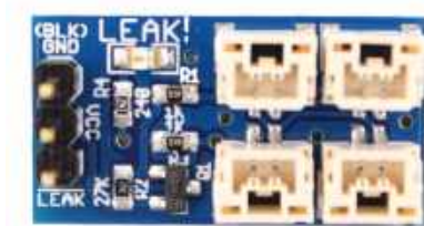
FIGURA 4.9: Placa eletrónica do SOS Leak Sensor . Fonte: obtido de BlueRobotics (2020d).
