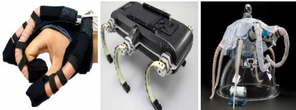
(A) Soft Rehabilitation Glove . (B) Soft robot X-RHex . (C) Soft robot OCTOPUS . Fonte: retirado de Laschi, Fonte: retirado de Laschi, Fonte: retirado de Laschi, Mazzolai e Cianchetti (2016). Mazzolai e Cianchetti (2016). Mazzolai e Cianchetti (2016).
