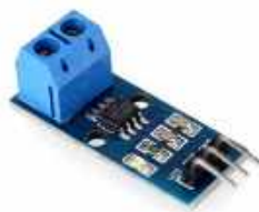
FIGURA 4.20: Sensor de medição corrente ACS712 30A . Fonte: obtido do website Mixtrónica 42 .
