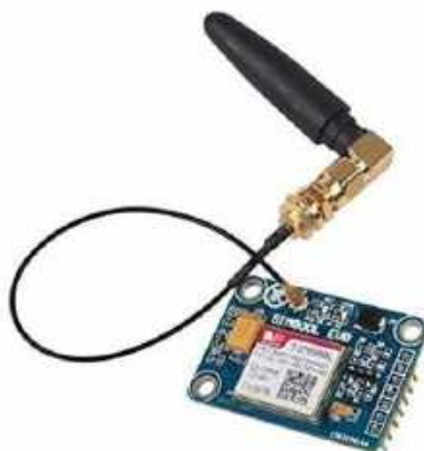
FIGURA 4.2: Visão 3D do SIM800 L GSM-GPRS 5V V2.0 . Fonte: obtido do website da Box Electrónica 28 .
