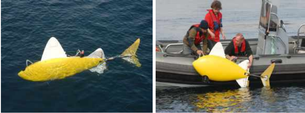
FIGURA 2.16: RoboShoal em testes no mar. Fonte: obtido do website Boiled Beans - SHOAL 13 .
