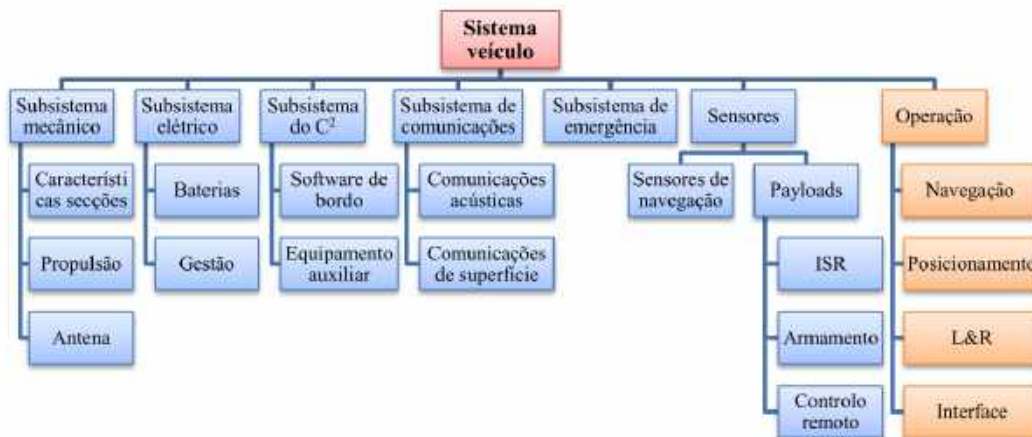
FIGURA 2.4: SBS de um AUV genérico. Fonte: retirado de Azevedo (2013).
