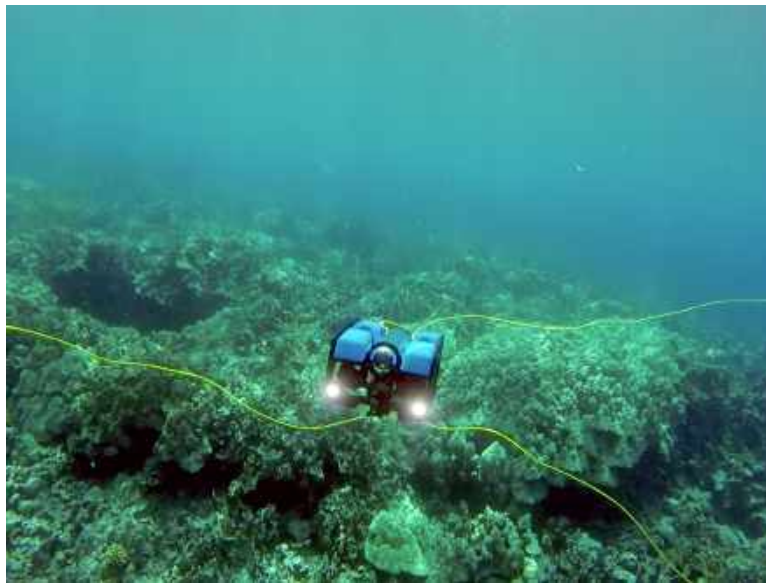
FIGURA 2.14: BlueROV2 em missão no ambiente aquático remotamente controlado por fibra ótica.
