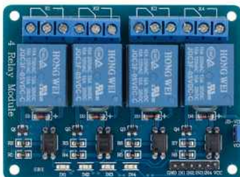
FIGURA 4.14: Módulo Relé 5V 4 Canais Fonte: obtido do website FILIPEFLOP 35 .
