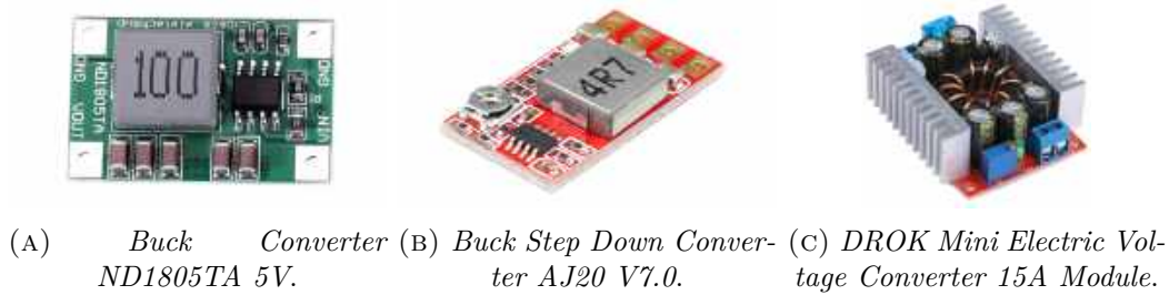
FIGURA 4.18: Reguladores de tensão utilizados.. Fonte: obtidos do website da Banggood 40 e da Amazon 41 .
