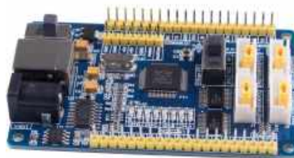
FIGURA 4.23: Hub 4 Port TTL Adapter. Fonte: obtido do website AliExpress 45 .
