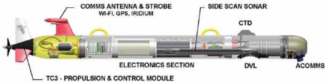
FIGURA 2.3: Constituição geral do AUV HarborScan. Fonte: retirado de Vehicle Control Technologies (2015).
