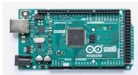
FIGURA 4.12: Arduino Mega 2560 . Fonte: obtido do website Arduino Mega 33 .
