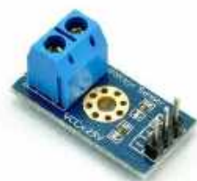
FIGURA 4.21: Sensor de medição de tensão B25 . Fonte: obtido do website ElectroFun 43 .
