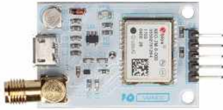
FIGURA 4.7: Sensor GNSS Velleman VMA430 equipado com o U-Blox NEO-7M .
