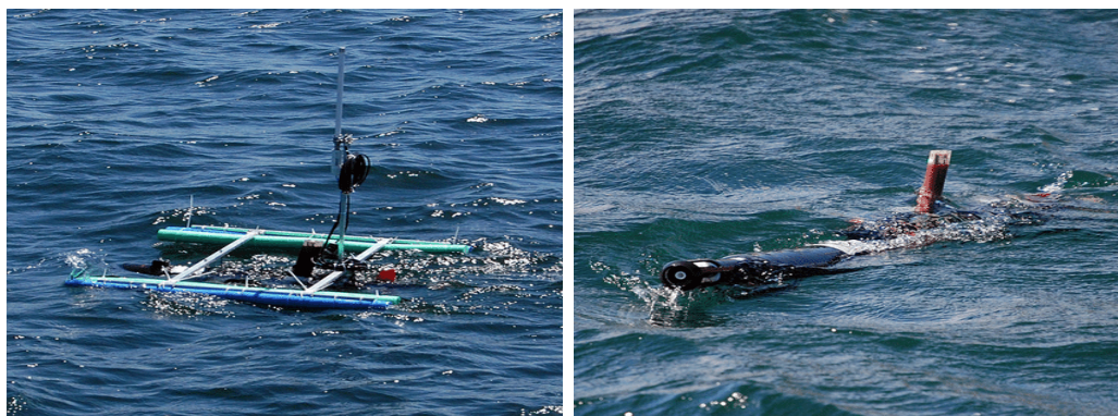
(A) SEACon no modo ASV. (B) SEACon no modo AUV.
