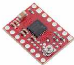
FIGURA 4.16: Driver do motor passo a passo MP6500 . Fonte: obtido do website Pololu 37 .
