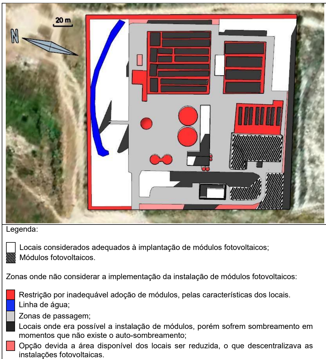
Figura 4.47: Ilustração da instalação fotovoltaica com 242 kWp.
