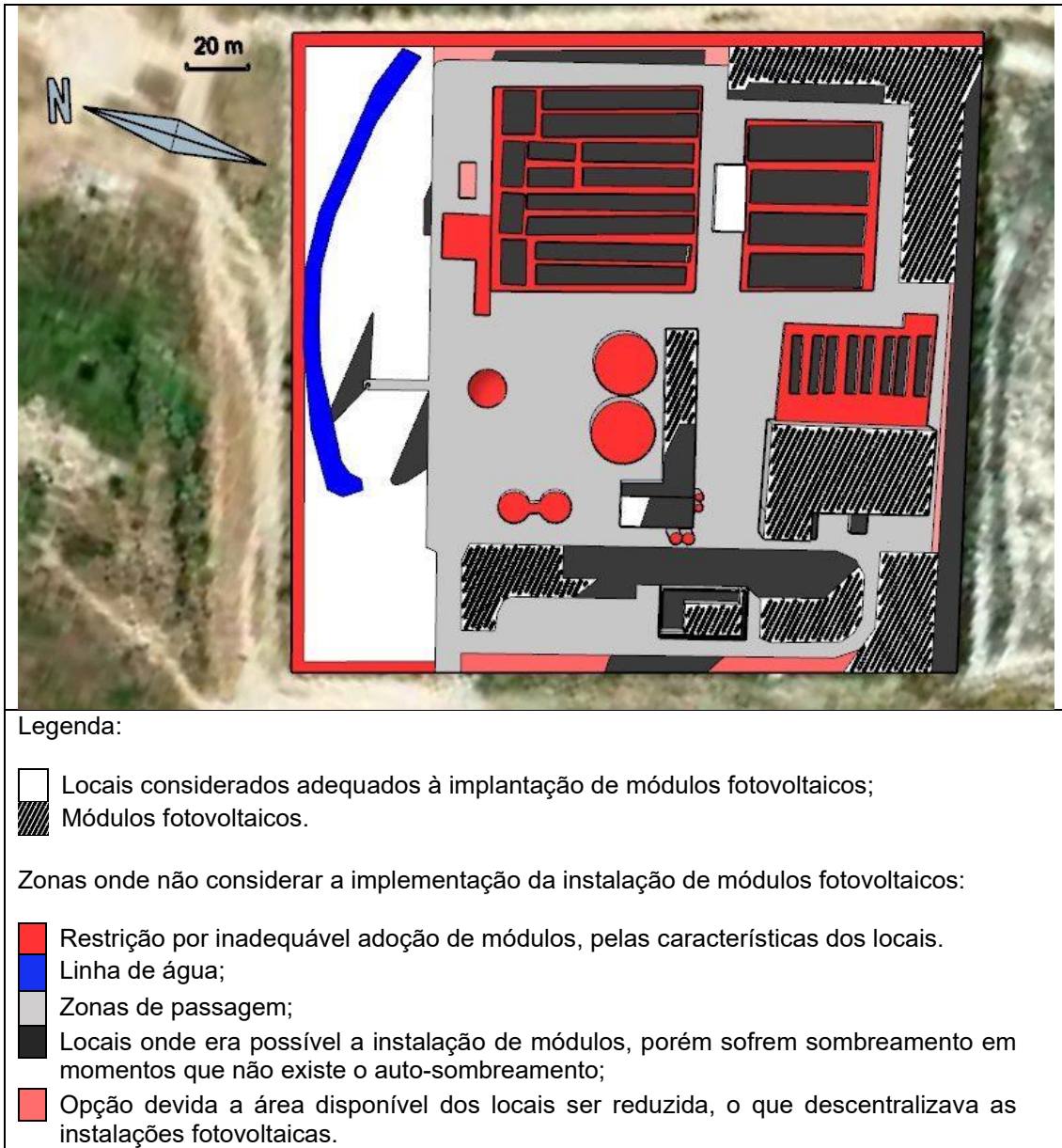
Figura 4.51: Ilustração da instalação fotovoltaica com 492 kWp
