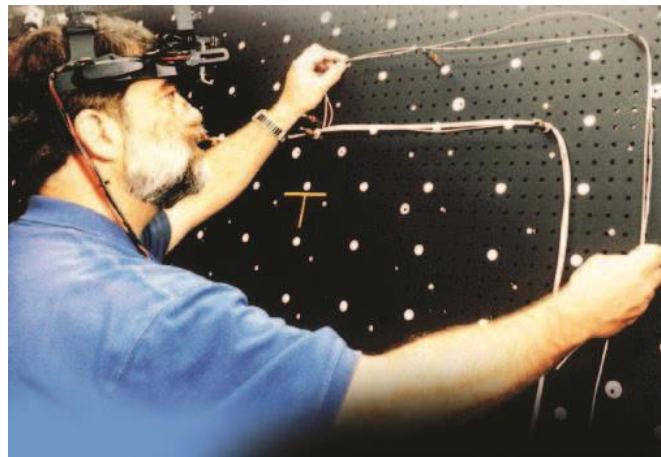
Figura 4: Operários da Boeing usaram um sistema AR na montagem de aviões.
