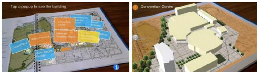
Figura 25: AR permite visualizar o modelo do prédio que ainda não foi construído.
