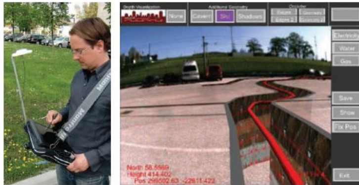
Figura 22: Escavação virtual revelando um cano de gás em AR. [Fonte: Höllerer e Schmalstieg (2016)].
