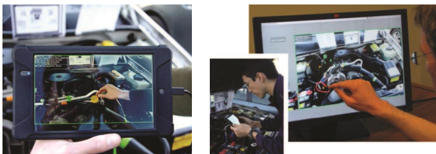
Figura 23: Reparação de automóvel assistida por um especialista remoto via AR. [Fonte: Höllerer e Schmalstieg (2016)].
