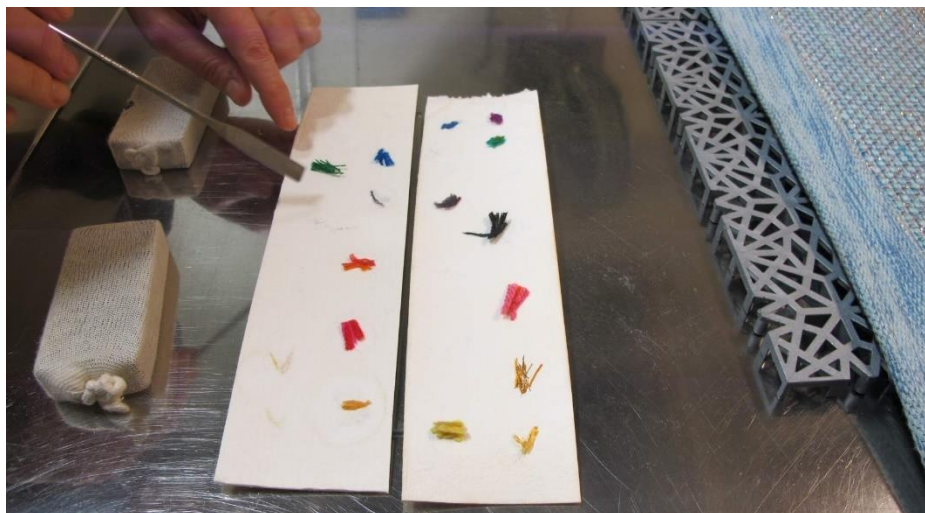
Figura 21 - Teste para verificar a estabilidade dos corantes durante o processo de limpeza por via húmida (©Marjorie Cohn)
