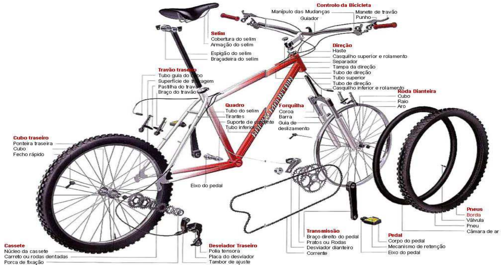
Figura 31: Componentes de uma bicicleta
