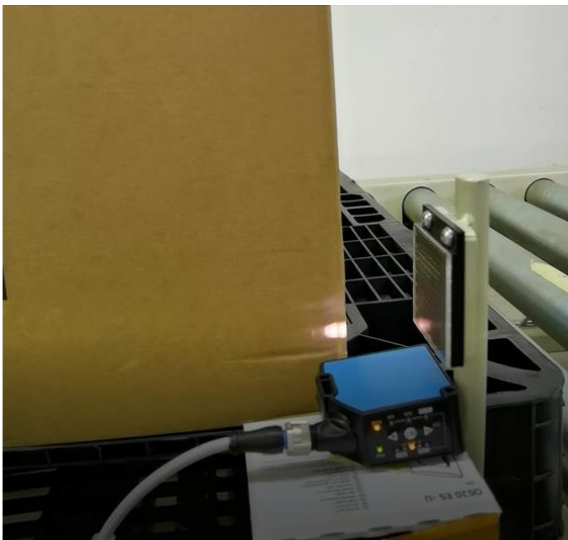
Slika 11: Test prepoznavne roba na valjčni progi II
