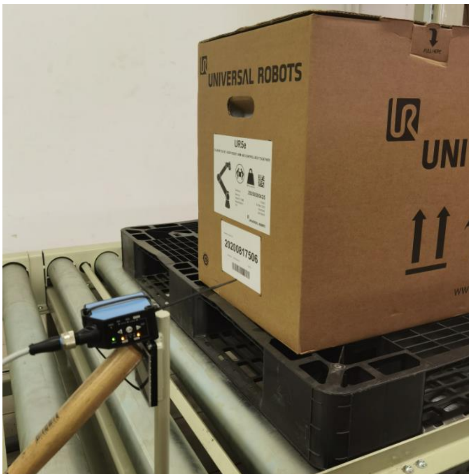
Slika 10: Test prepoznavne roba na valjčni progi I
