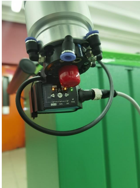
Slika 13: Integracija senzorja na robotsko roko
