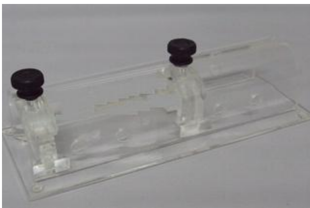
Figura 7. Tubo de acrílico utilizado para o procedimento de restrição (Adaptada de Padovan e Guimarães, 2000).
