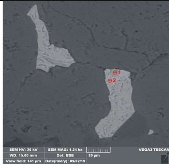
Слика 42с. Позиции од изведени анализи под SEM, детаљ 1.
