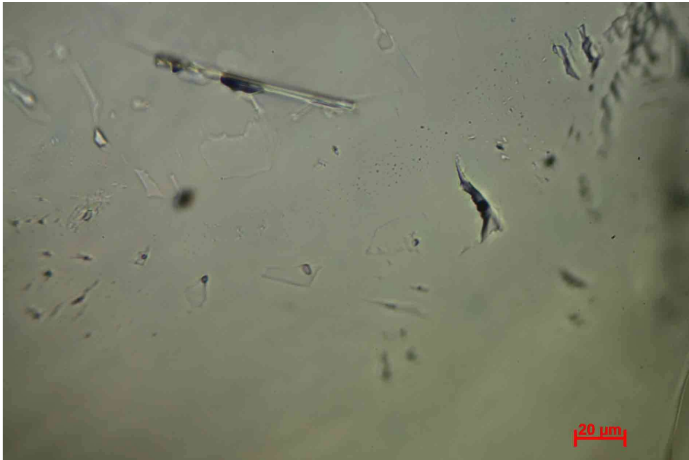
Слика 78. Фотографија на изолирани групации на примарни гасно-течни инклузии (пропуштена светлина, паралелни николи).
