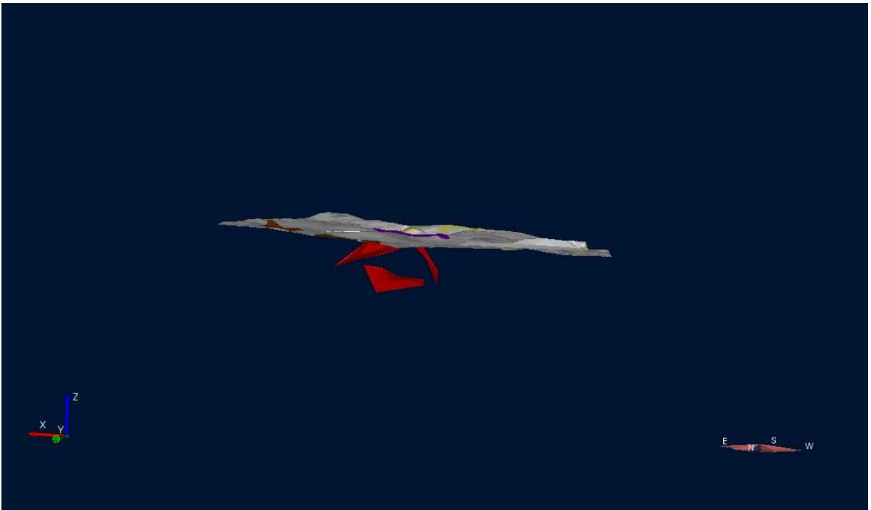
Слика 103. 3Д површинска геологија и некои од главните раседи кои се добиени од попречните профили, област Боров Дол.
