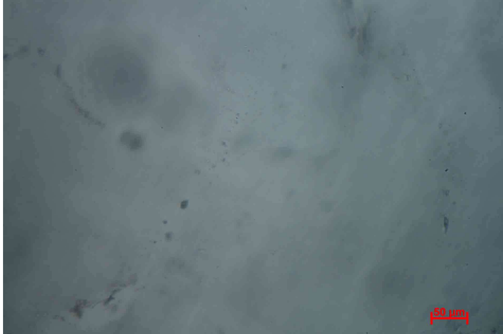
Слика 79. Фотографија на секундарни инклузии настанати долж зараснати пукнатини (пропуштена светлина, паралелни николи).
