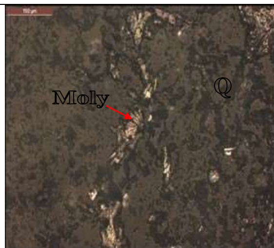
Слика 41б. Микрофотографија на дисконтинуирана кварц-молибденитска жица со молибденитски прачки во вид на радиални зраци. Зг. x 200 II (BD-338; 70,00 m).
