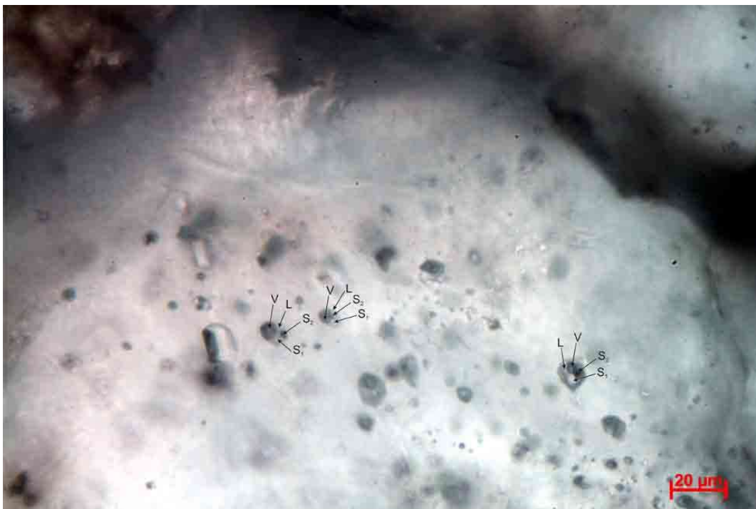
Слика 82. Фотографија на повеќефазни гасно-течни инклузии кои содржат течност (L), пара (V), транспарентна изотропска цврста фаза (S1) и нетранспарентна цврста фаза (S2) (пропуштена светлина, паралелни николи).
