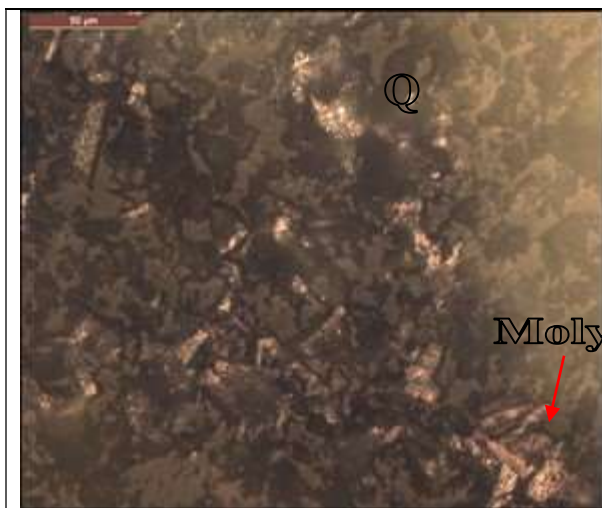
Слика 41а. Микрофотографија на прачкаст агрегат на молибденит во кварц-молибденитска жица. Зг. x 400 II (BD-338; 70,00 m).
