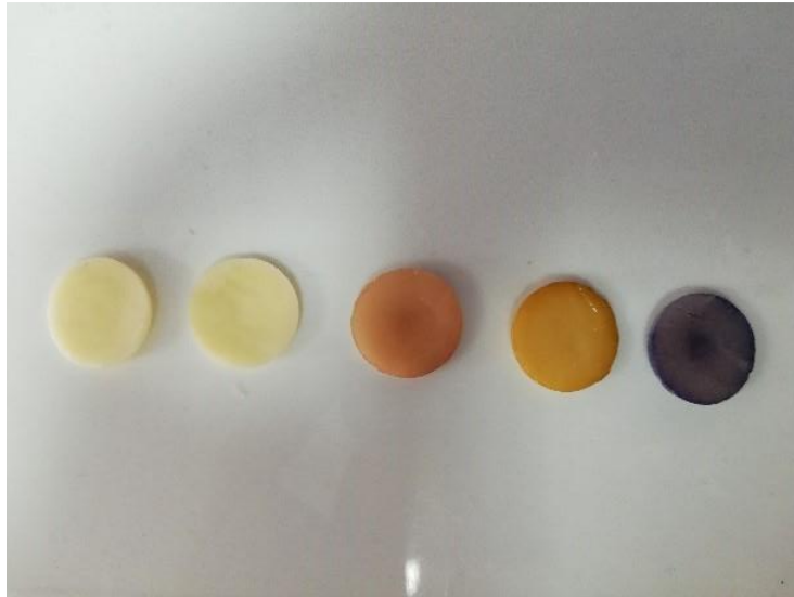
Слика 13. Примероци од дисковите после периодот на тестирање. Од лево кон десно: контролна група, кока-кола, вино, кафе и чај.
