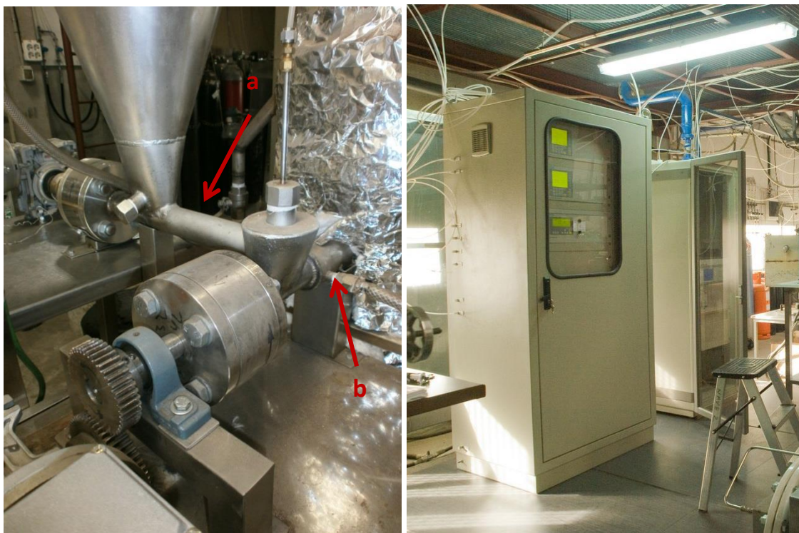
Figura 4.7. Doble tornillo sinfín. a) Tornillo sinfín regulador y b) tornillo sinfín rápido. Figura 4.8. Analizadores de gases.
