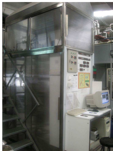
Figura 3.9. Esquema y fotografía de la planta CLC en continuo de 500 W t adaptada para operar con sour gas y acid gas .
