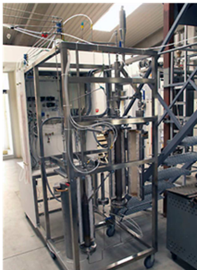
Figura 3.8. Esquema y fotografías de la planta CLC en continuo de 500 W r .
