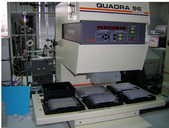
Figura A.1. Fotografía del robot manipulador de líquidos, con placas multipocillo en sus diferentes estaciones.
