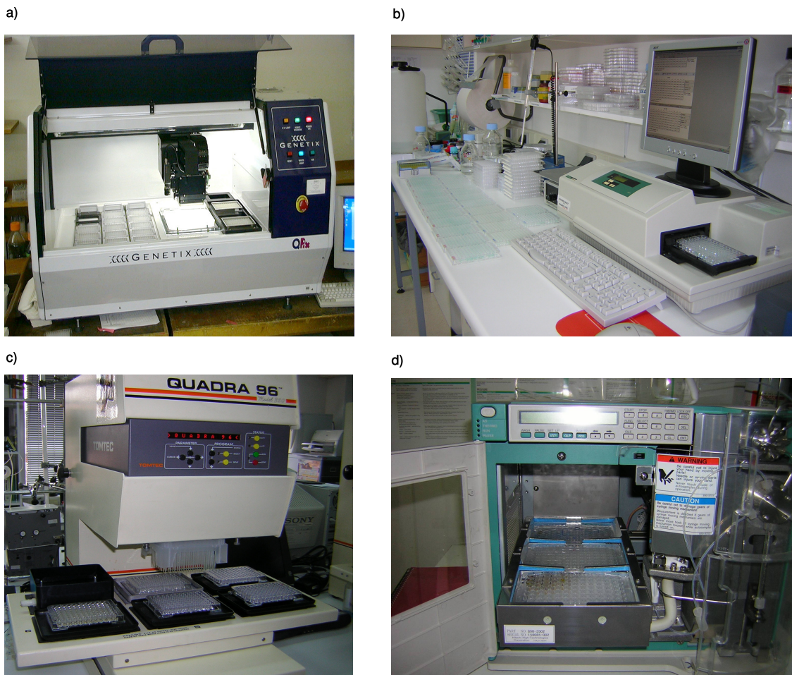
Figura 1.4. Equipamiento para HTP-screening. a) Robot picador de colonias. b) Lector de microplacas. c) Robot manipulador de líquidos. d) Inyector automático HTP para HPLC.
