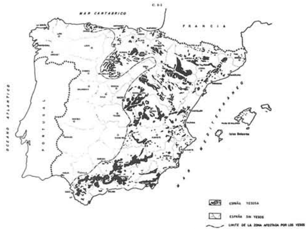
Fig. 6. — Distribución esquemática de los terrenos yesíferos en España.
