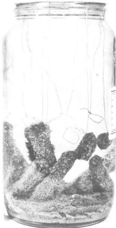
Fig. 10. — Estado de las probetas de mortero (1:3) sumergidas en un medio agresivo.
