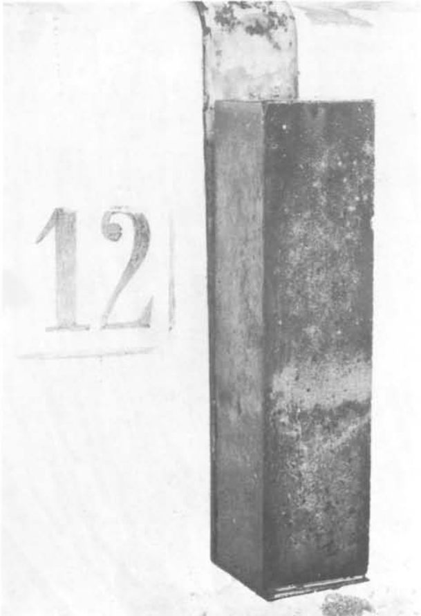
Fig. 12. — Probeta de hormigón sometida a la acción del agua de mar.
