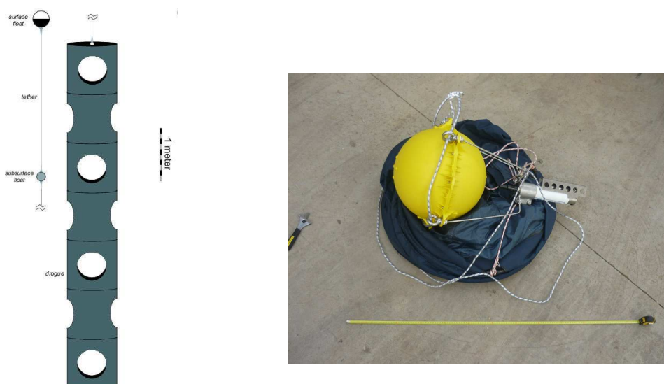
Figura 1.2. Esquema del disseny original de boia de deriva SVP i il·lustració d'una boia utilitzada a la campanya SPURS.
