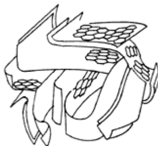
Figura 1.9. Representación esquemática de la estructura de un carbón activado.
