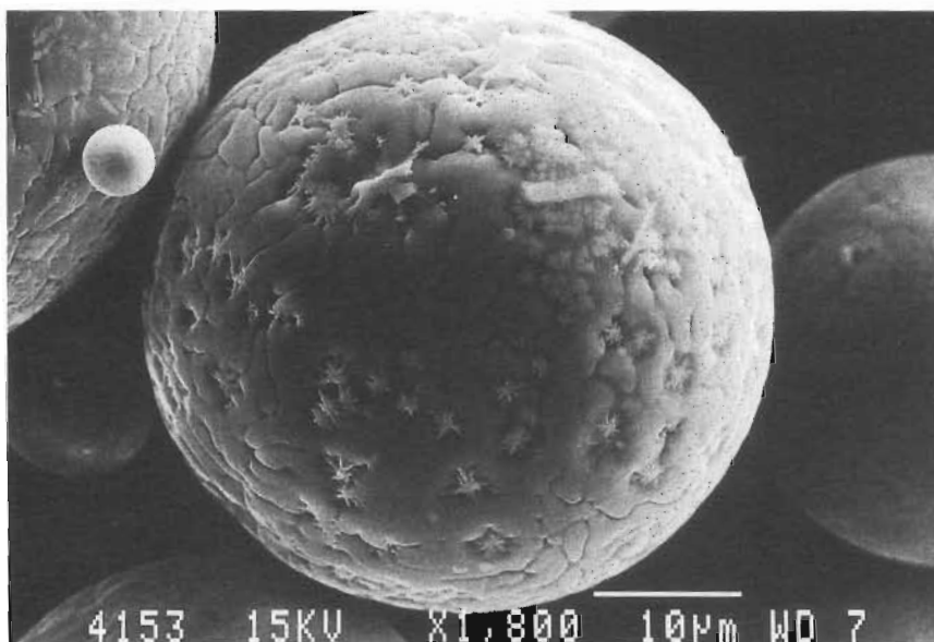
Fig. 19.5. Al-Cr-Mo solidificada rápidamente. Imagen de electrones secundarios.
