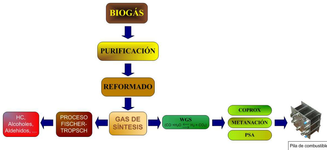
Fig. 1.8. Procesado indirecto de biogás
