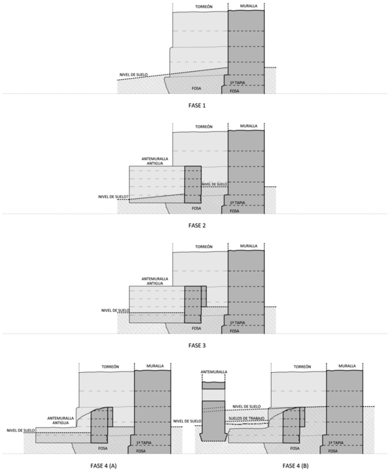
Fig. 132. Murcia. Evolución de las antemurallas en el tramo excavado en el sector oriental del antiguo convento de Verónicas
