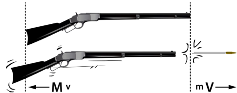
Imagen 21. Ilustración del principio de conservación de la cantidad de movimiento en una escopeta.
