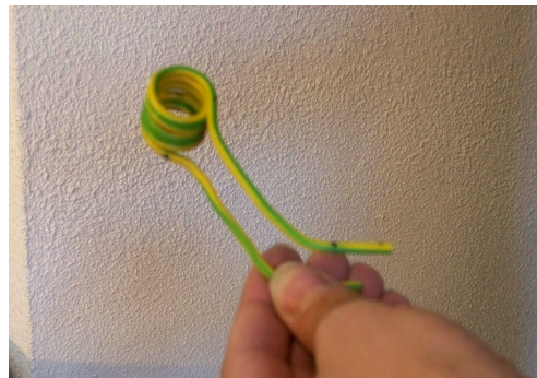
Imagen 4. Realización del modelo de máquina de cinco espiras con cable de cobre.
