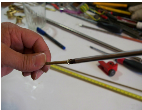
Imagen 6. Relleno del tubo con arena fina.
