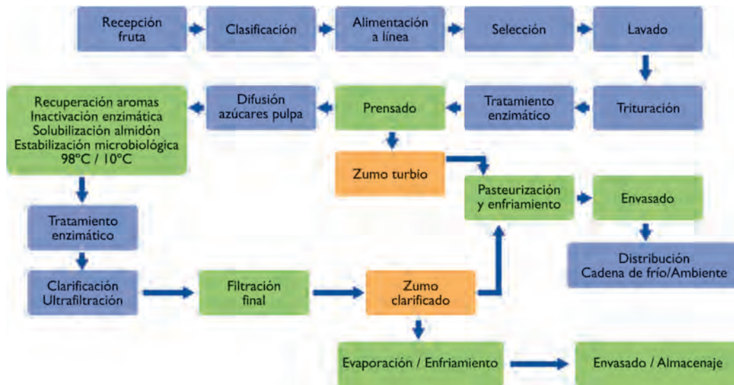
▲ FIGURA 5.13.- Línea de producción de zumo clarificado.
