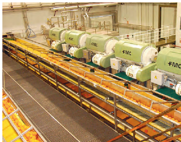
▲ FIGURA 5.4.- Detalle de la cinta de alimentación inclinada.
