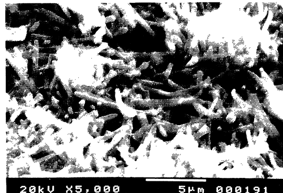
Figura 9.- Mortero MT4 después de 4 meses de tratamiento. EDX y microfotografía de cristales de taumasita o disolución sólida taumasita-etringita.
