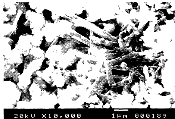
Figura 3.- Mortero MT1, 4 meses mantenido a 5 °C. Microfotografía y análisis EDX de las agujas identificadas como thaumasita o disolución sólida etringita-thaumasita.
