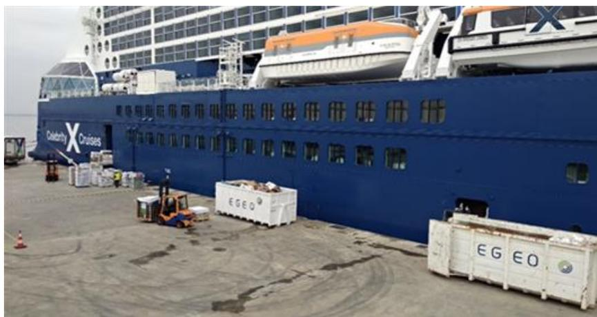
Figura 20. Abastecimento e descarga de resíduos a um navio em simultâneo
