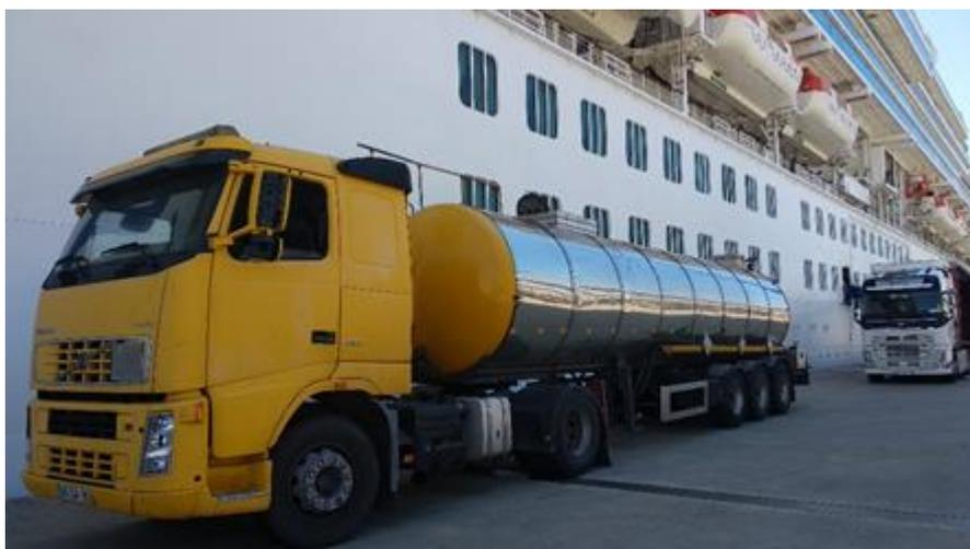
Figura 17. Recolha de águas residuais num caminhão cisterna
