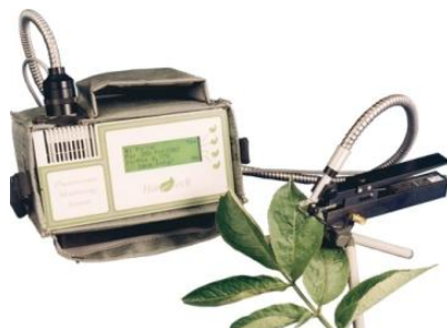
Figura IV.4. Fluorímetro modulado portátil.
