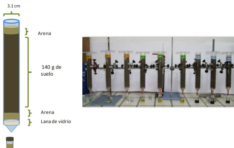
Figura II.11. Columnas de vidrio empaquetadas a mano con los suelos sin enmendar y enmendados para los estudios de movilidad.
