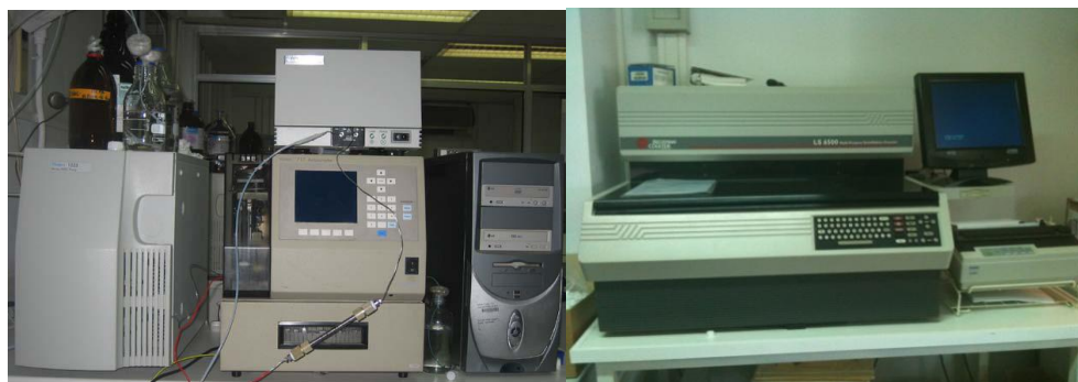
Figura II.3. HPLC (izquierda) y contador de centelleo (derecha).
