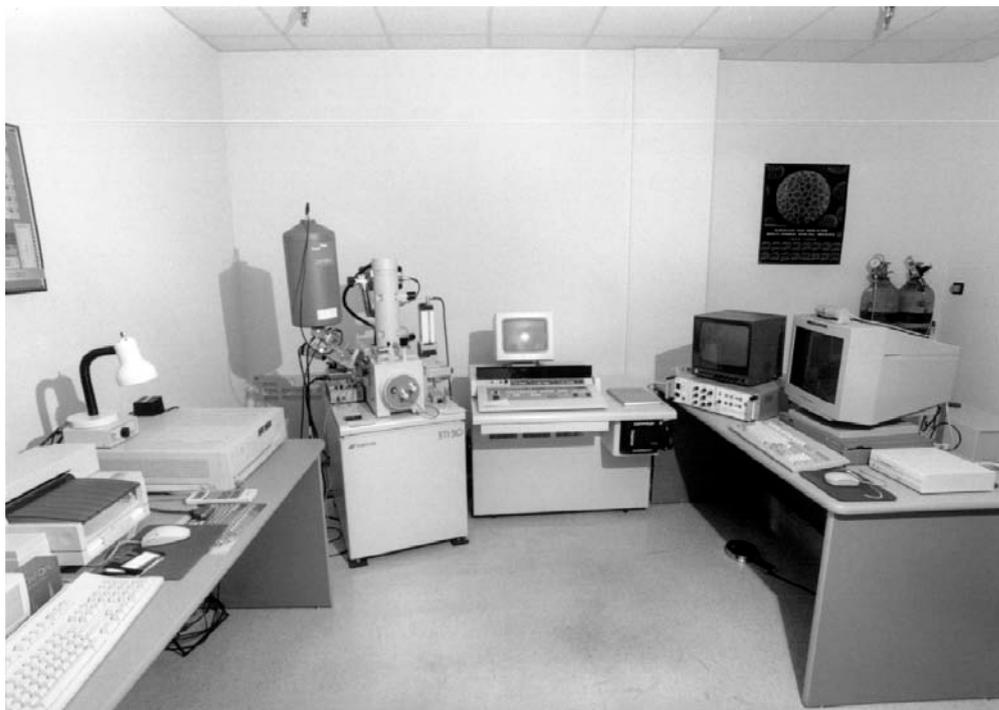
Fig. 2.3 Sistema de EBSD utilizado para la determinación de micro y mesotexturas en este trabajo. (Escuela Naval para Posgraduados en Monterey, California, EEUU).
