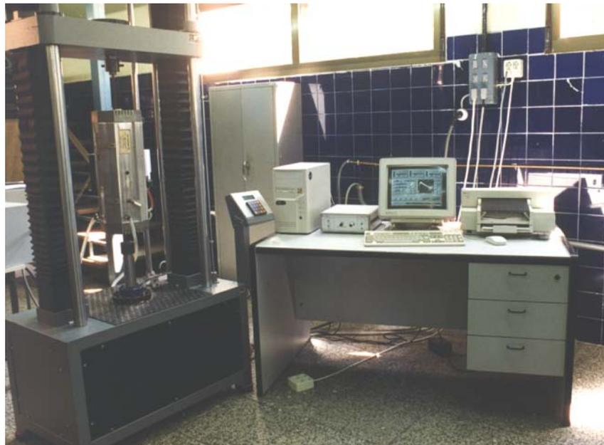
Fig.2.7 Máquina de tracción provista de un horno de radiación que permite realizar ensayos a temperatura elevada.
