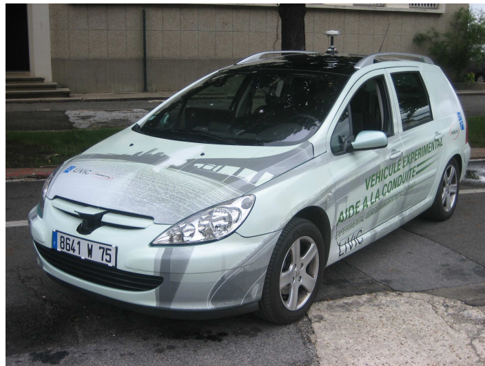
Figura 4.1: Vehículo prototipo del LIVIC.
