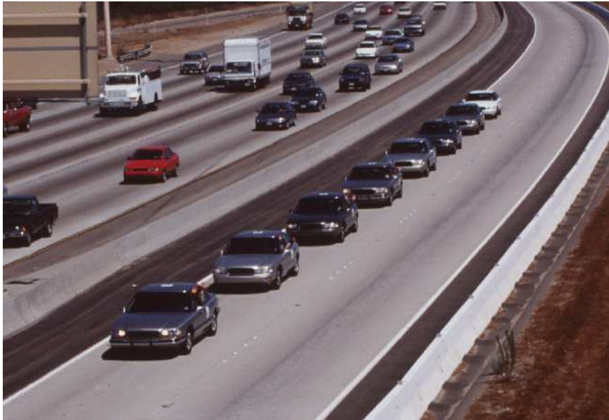
Figura 2.6: Vehículos del programa PATH durante el experimento de platooning .
