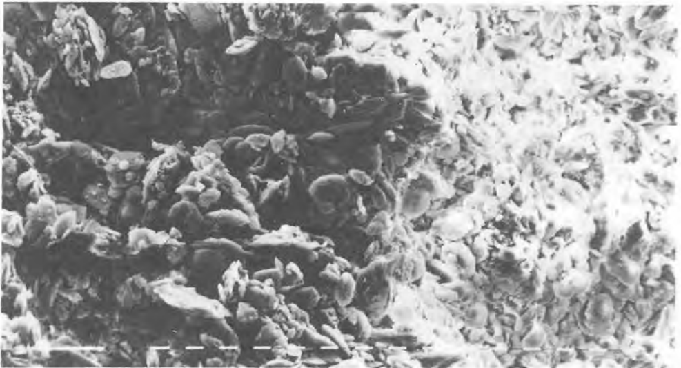
Fig. V.3.5.21. El yeso lenticular (izquierda) y el microcristalino (derecha) tiene diferente comportamiento óptico en las secciones delgadas, pero su aspecto a pequeños aumentos del M.E.B. es parecido. 1 trazo = 10 \mu m. Horizonte 2 By, pedión 1B-138.
