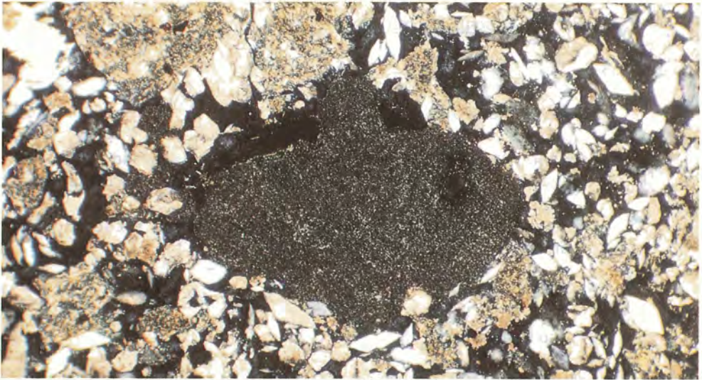
Fig. V.3.1.7. Nódulo de yeso microcristalino asociado a una raíz. El material circundante consta de cristales de yesparita, lentillas de yeso y fragmentos de quedecal, todo ello en empaquetamiento suelto. Lám. 153-3. Lado mayor: 2mm.
