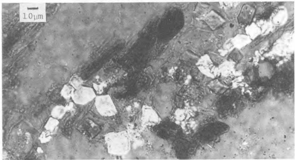
Fig. V.3.5.14. Detalle de los cristales euhedrales que se atribuyen a whewellita. Nicoles parcialmente cruzados. Lám. 138: 89-97.
