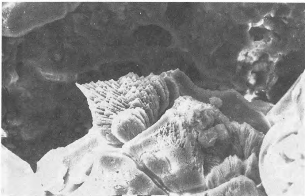
842 0004.jpg Fig. V.3.5.35. Detalle de la figura V.3.5.32. Formas de corrosión/crecimiento concordantes con las líneas curvas convergentes visualizadas al microscopio polarizante en el interior de muchos granos de quesparita. Al fondo túneles de los quehuecos en la quedecal. 1 trazo = 10 \mu m. Pedión IB-138.
