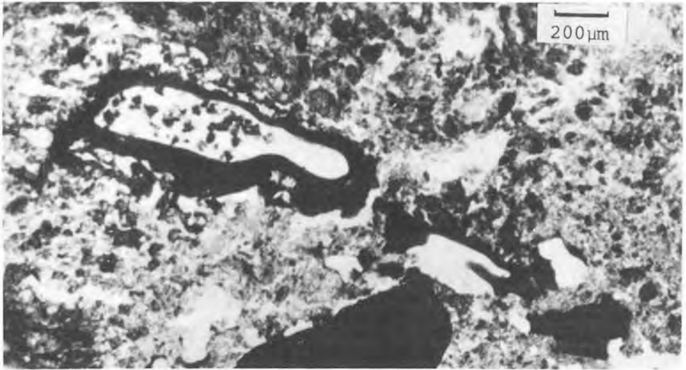
Fig. V.3.5.8. Revestimientos limo-arcilloso en un canal de fauna. El soporte de este edaforrasgo es una masa basal gypsica lenticular. LPP. Lám. 138: 89-97.
