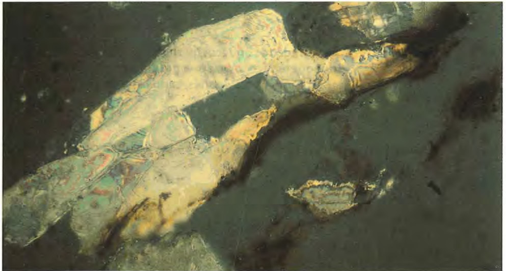
Fig. V.3.15.5. Detalle de la anterior mostrando cristales de quesparita fracturados y vainas orgánicas. Lado mayor 0.34 mm. Nícoles a 45°. Lám. 15: 24-36.
