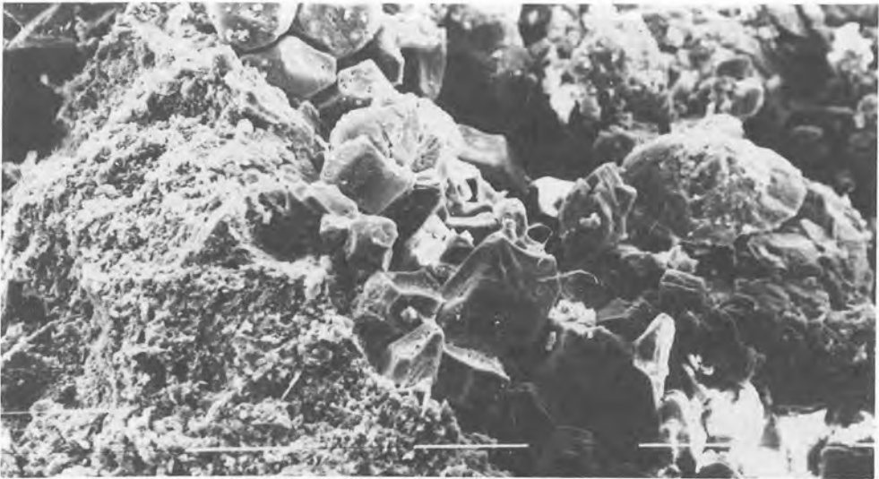
Fig. V.3.5.40.- De centro a derecha: cristales de quesparita y yeso lenticular. 1 trazo = 100 \mu m. 8420006.jpg
