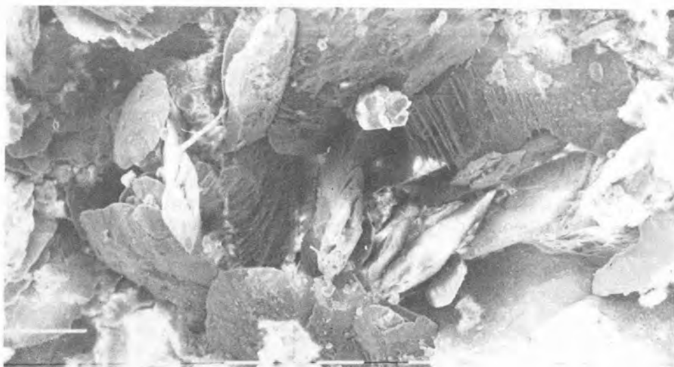
Fig. V.3.3.10. Detalle del yeso lenticular. Hay gran porosidad entre lentillas, utilizada por filamentos biológicos. 1 trazo = 100 \mu m. Muestra del pedión 135, entre 66 y 78 cm.
