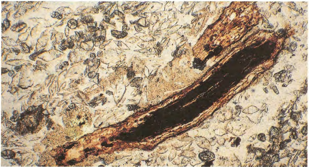
Fig. V.3.1.8.- En luz paralela el yeso microcristalino es amarillento. Masas irregulares asociadas a un residuo de raíz. Lado mayor: 2mm.
