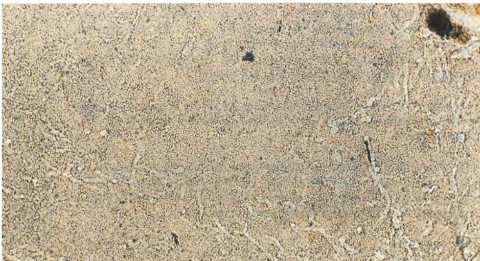
Fig. V.3.1.9.- Secciones transversales y longitudinales de canales (10 a 15 \mu\text{m} de diámetro) en un nódulo de yeso microcristalino. Pueden deberse a hifas o a pelos radiculares. Lám. 153-3.
