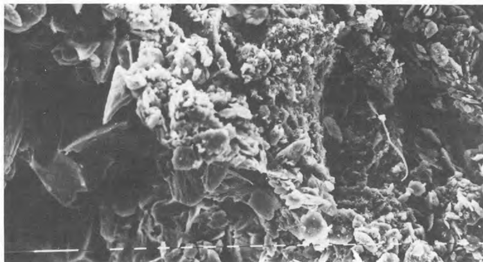
Fig. V.3.5.24. A la izquierda granos de quesparita de tamaño superior a 60\ \mu\text{m} , junto a ellos algunas lentillas de yeso y la masa decalcificada (quedecal). 1 trazo = 10\ \mu\text{m} . Pedión IB-138.
