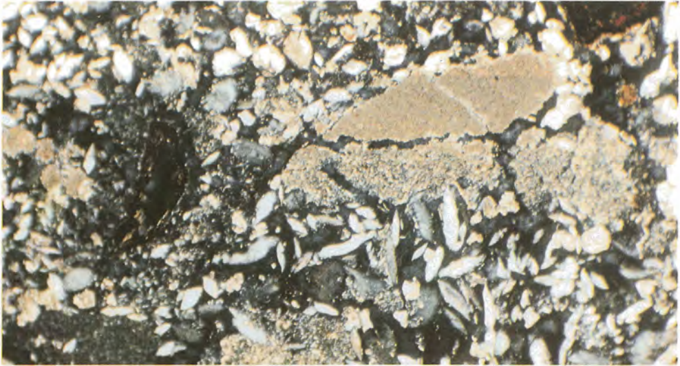
Fig. V.3.1.13.- Sobre un fondo de yeso lenticular y cristales de quesparita hay material agregado correspondiente a quedecal. Se puede observar un fragmento mixto cuyas partes micrítica y quedecal se están separando. LPX. Lám. 153-3. Lado mayor: 2 mm.
