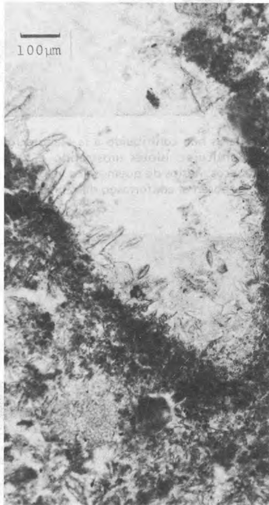
Fig. V.3.5.18. Detalle de las dos figuras anteriores. Sobre el revestimiento de limo carbonático hay otro de yeso con lentillas dispuestas radialmente. LPP. Lám. 138: 168-182.
