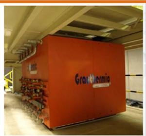
La nueva tecnología (GRAUTHERMIC-CSIC)<sup>®</sup> se basa en el aprovechamiento de todos los productos generados en el proceso. Los gases, se convierten en electricidad mediante turbinas generadoras; los líquidos, en combustibles o bien, en energía eléctrica mediante el uso de una nueva turbina generadora basada en tecnología Phanthone y los sólidos residuales, se utilizan para diversas aplicaciones.
