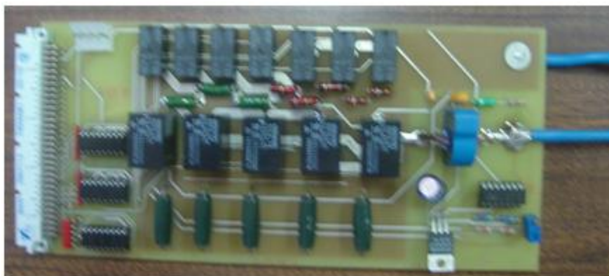
Figura 4.17. Sistema de carga electrónica incorporado al control integral de pilas.
