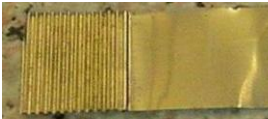
Figura 3.1. Lámina de 0,1mm de espesor parcialmente corrugada.
