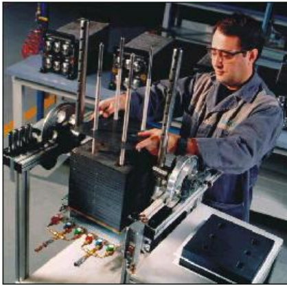
2.4a. Montaje de un stack PEM
