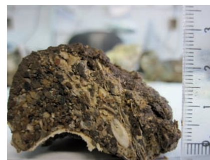
Fig.4.- Depósito formado por restos vegetales silicificados mezclados con terrígenos siliciclásticos.
