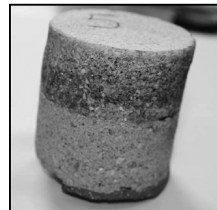
Figura 4. Aspecto completo de la muestra: capa vista, capa base o revés de la piedra artificial, amorterado y tabiquillo de ladrillo hueco.
