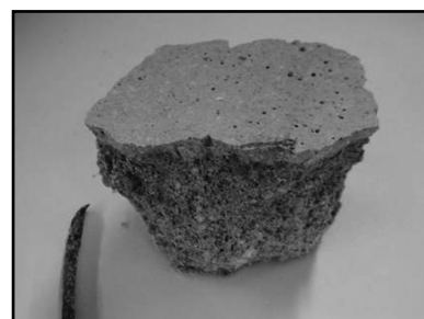
Figura 12. Estado después del ensayo a compresión.
