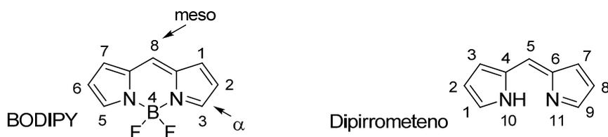
Figura 2.23. Estructura y numeración del núcleo BODIPY y de su dipirrometeno precursor
