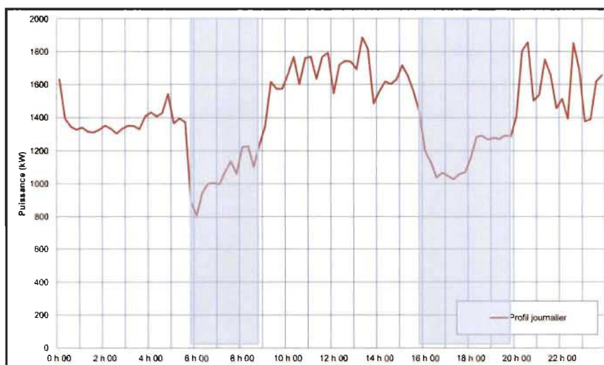
Figure 3-6 : Résultats projet pilote Édifice à bureaux [56]
