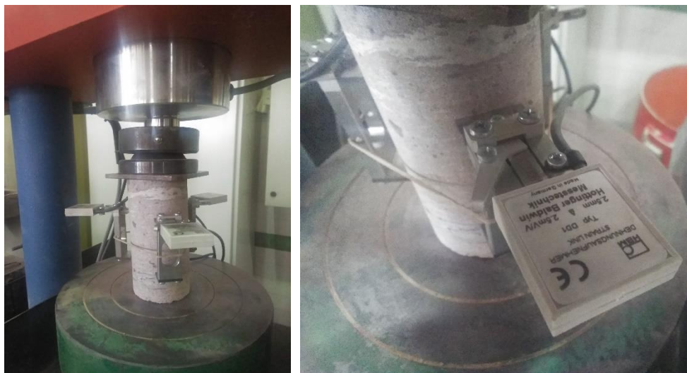
Fig. 96. Ensayo de módulo de elasticidad norma UNE-ENE 14580, en el laboratorio de tecnología de estructuras de la UPC
