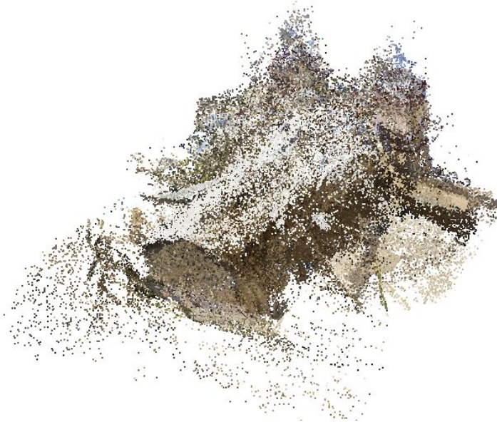
Fig. 30. Modelo de puntos dispersos de la iglesia San Juan Bautista de Huaytará.
