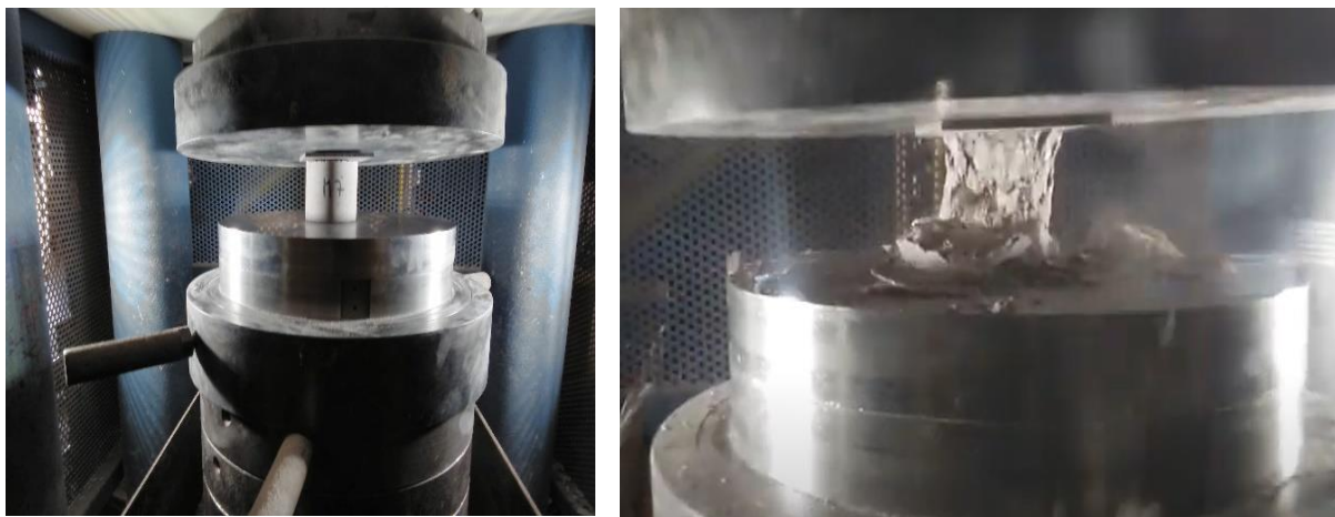
Fig. 94. Ensayo de compresión uniaxial en unidades de las probetas de Rocas INCA (laboratorio UPC)
