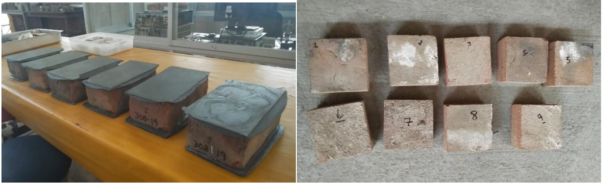
Fig. 85. Muestras de ladrillo preparadas en el laboratorio PUCP, contemporáneo (izquierda), antiguo (derecha)
