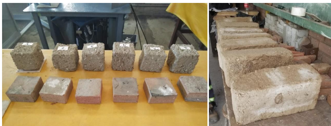
Fig. 90. Muestras de adobe (derecha) y probetas cubicas para ensayo uniaxial de adobe de la iglesia san Juan Bautista de Huaytará.
