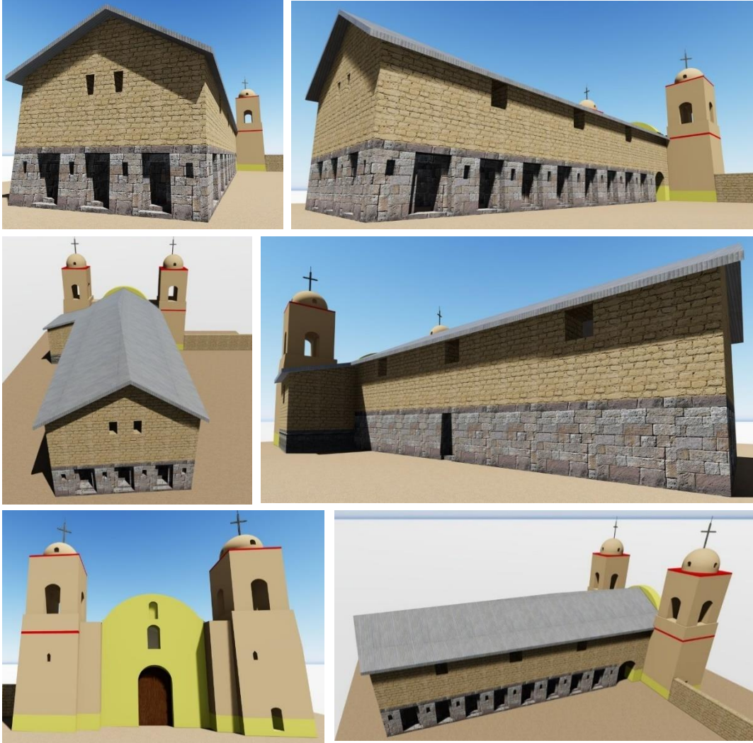
Fig. 36. Vistas de modelos geométricos 3D texturizados en un entorno CAD a partir de la superficie del modelo fotogramétrico.
