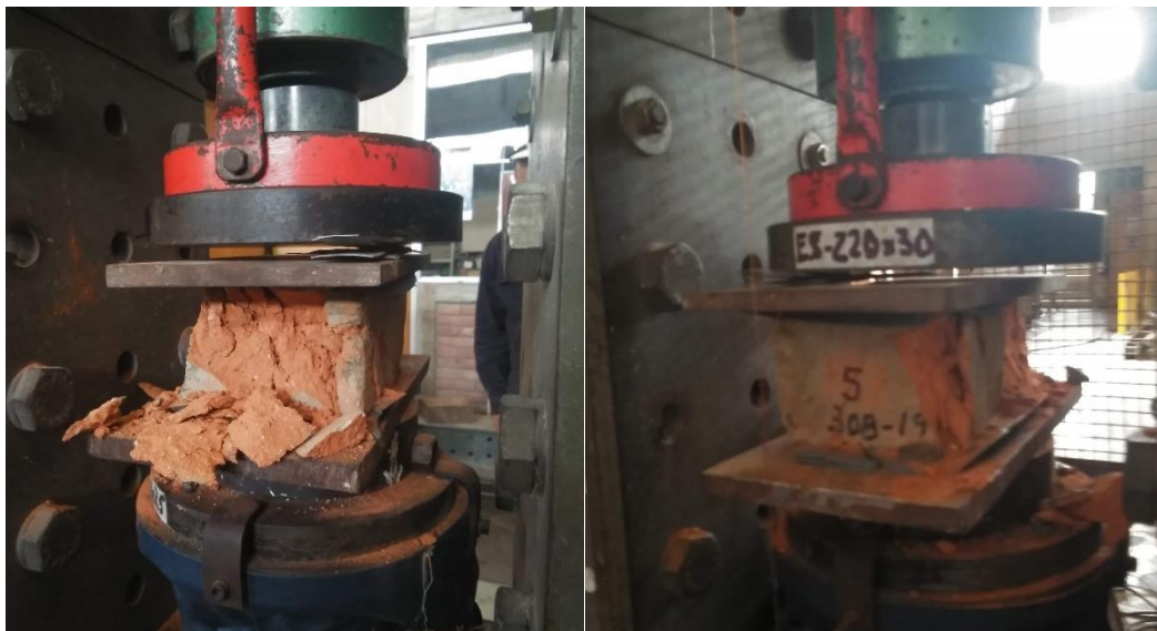
Fig. 86. Ensayo de compresión uniaxial de las unidades de ladrillo contemporáneo en el laboratorio de la PUCP.
