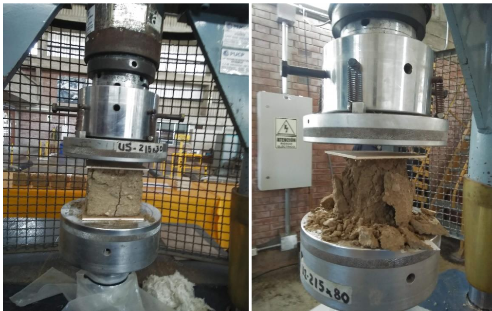
Fig. 91. Ensayo de comprensión uniaxial en unidades de adobe (laboratorio LEDI - PUCP).
