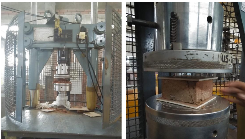
Fig. 87. Ensayo de compresión uniaxial de probetas talladas de ladrillos antiguos.
