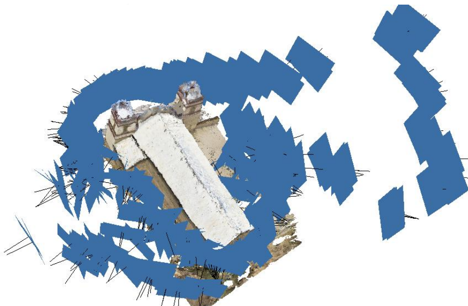
Fig. 29. ubicació de les càmeres desde donde se tomaron las fotografías para el modelado fotogramétrico.
