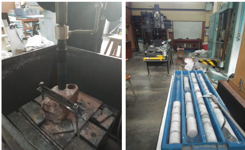
Fig. 93 Extracci3n de probetas de roca de 5 cm de di2metro, mediante diamantina.
