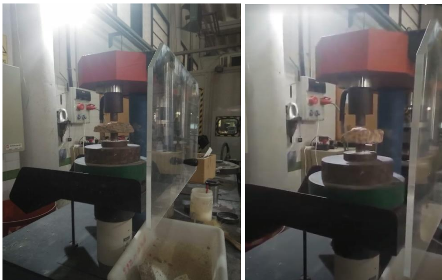
Fig. 100. Ensayo de doble punzonamiento de mortero de ladrillo contemporáneo (izquierda) y antiguo (derecha)
