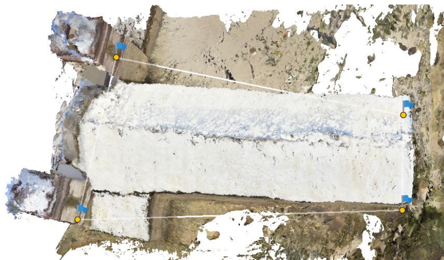
Fig. 34. Marcadores en la base del edificio histórico utilizados en el escalado
