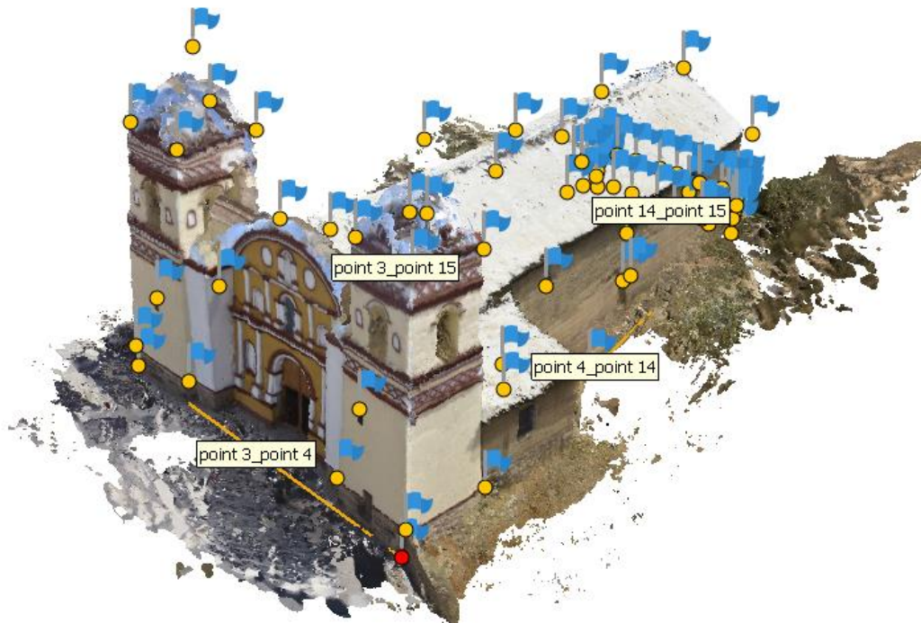
Fig. 35. Distribución de los marcadores para la corrección del modelo 3D
