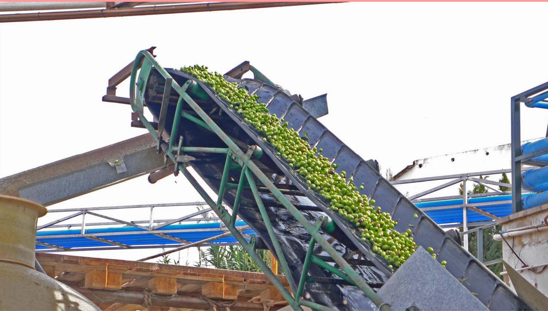
*Esta cinta las lleva hasta la boca del fermentador de 5000 kilos*
