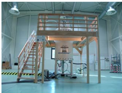
Figura 4.4: Espectrómetro Bruker Avance de 800 MHz de la Universidad de Ciencias y Tecnología de Lille (Francia).
