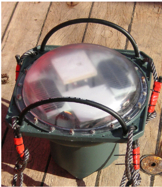
Figura 15 Boya GPS con paneles solares y luz de localización.
