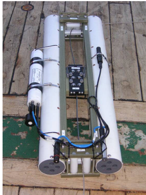
Figura 16 El WireWalker es un vehículo que sube y baja un cable vertical bajo de una boya por la acción de las olas superficiales. En esta foto, se ven también el CTD (izquierda) y sensores de turbidez (izquierda), fluorescencia (derecha) y oxígeno (derecha, arriba).
