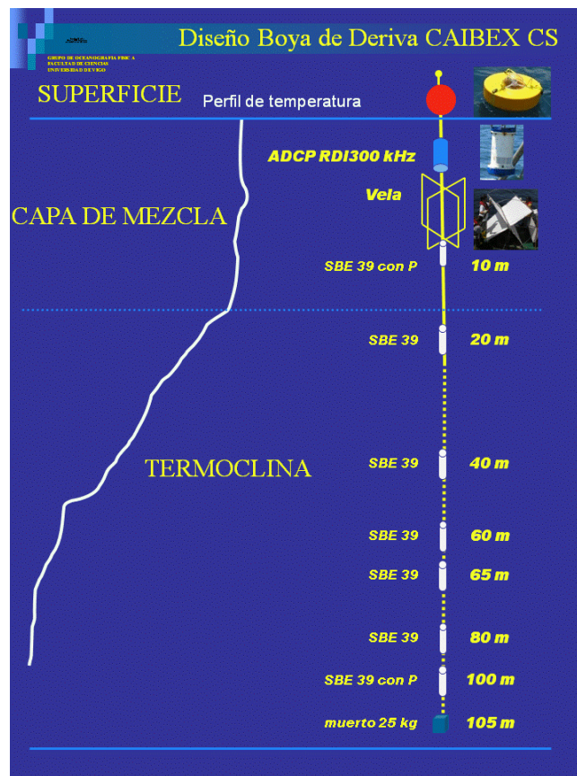
Figura 24 Esquema de la boya física con su ADCP, vela y cadena de termistores en los primeros 100 m de la columna de agua durante el 1º experimento lagrangiano y 70 m en el segundo.
