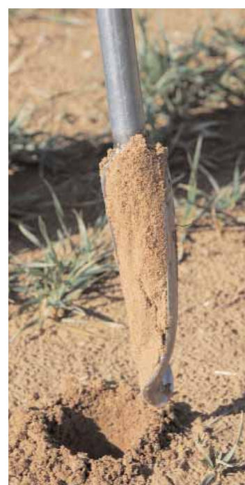
Extracción de una muestra de suelo.
