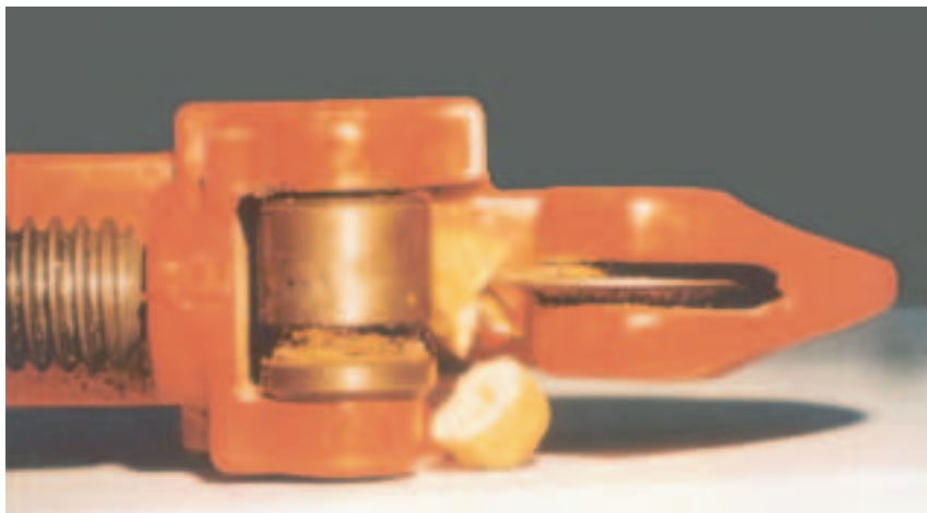
3. USO DE UN CORTATUBOS para la eliminación de la cubierta de la semilla de olivo ( Olea europaea ).
