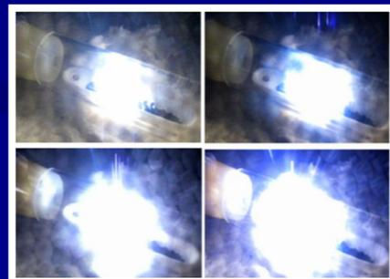
El proceso se encuentra favorecido si se produce con microondas, ya que la conversión es prácticamente del 100% debido a la formación de microplasmas y se pueden utilizar materiales carbonosos baratos que se regeneran durante el propio proceso
