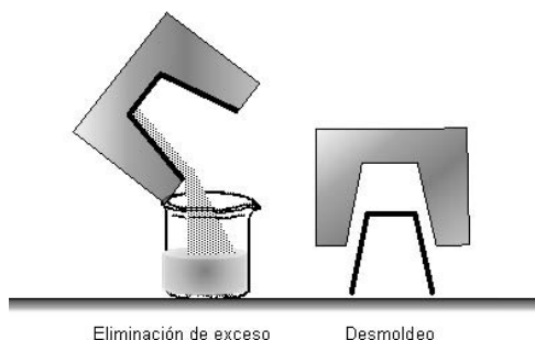
Figura 7. Etapas del proceso de colaje de suspensiones, que incluyen el vertido en el molde, la filtración, la eliminación del exceso de suspensiones y el desmoldeo cuando se ha filtrado el líquido hasta el espesor deseado.
