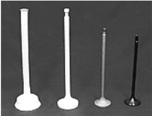
Figura 4. Etapas de procesamiento de un material cerámico desde el conformado hasta el acabado final.
