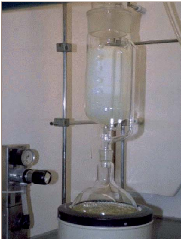
■ Figura 4. Extracción de filtro + PUF en Soxhlet.
