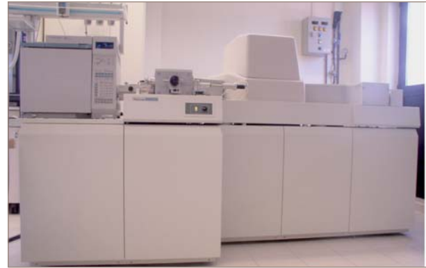
■ Figura 6. Cromatógrafo de gases de alta resolución acoplado a un espectrómetro de masas de alta resolución (HRGC / HRMS).
