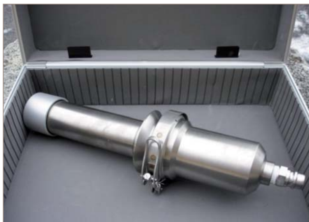
■ Figura 3. Cartucho porta-filtros: contiene filtro de partículas (eficiencia >99,5%) y PUF.
