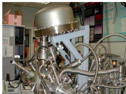
Figura 3. Fotografía de espectrómetro de electrones de rayos X (XPS), dedicado al análisis de la composición química y de la estructura electrónica de películas delgadas. El instrumento cuenta con dos reactores anexos para el tratamiento y la fabricación in situ de sustratos y películas delgadas.
